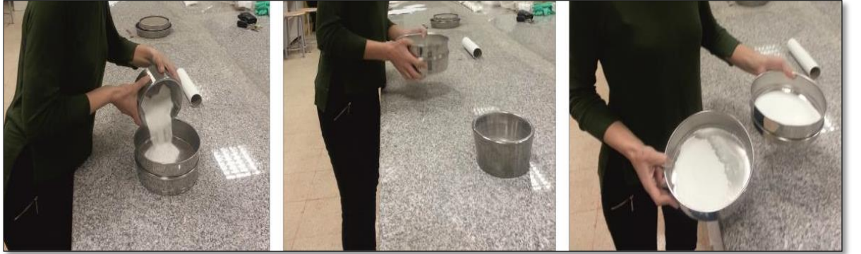
Şekil 3.17. Öğütülmüş numunelerin eleme işlemleri
