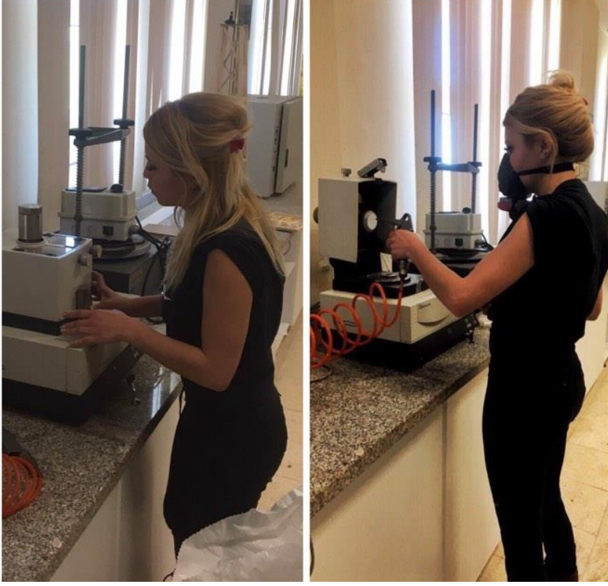
Şekil 3.16. Numunelerin analize hazırlanması havan ile öğütme işlemleri
