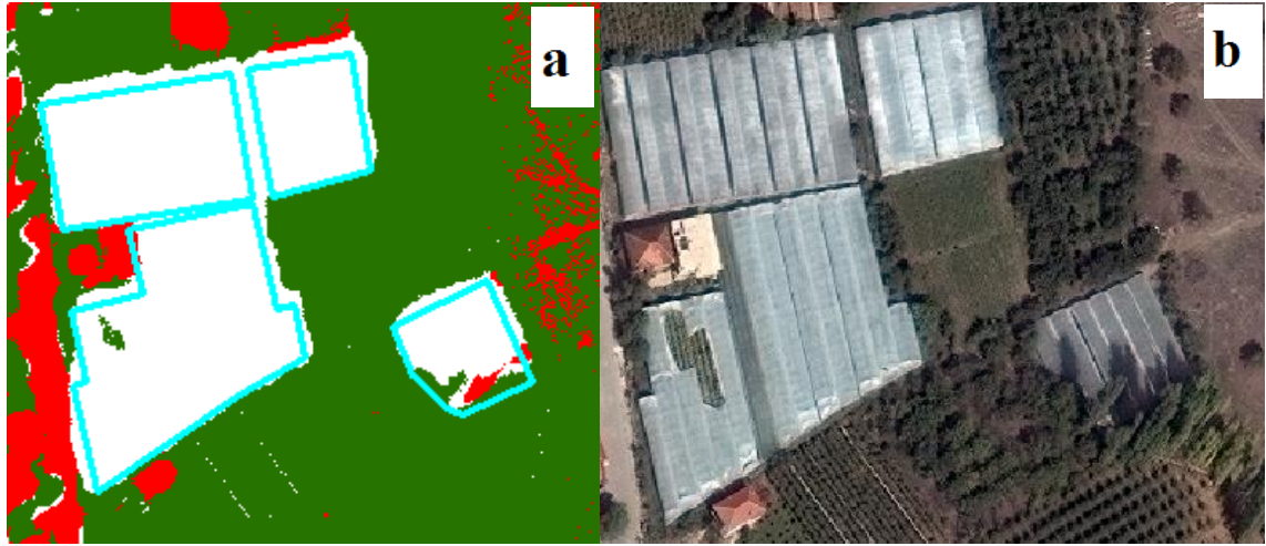
Şekil 4.10. a) Sera pikselleri b) Uydu görüntüsü görünümü
