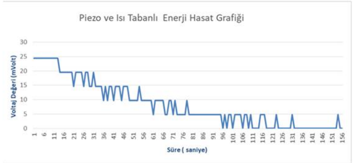
Şekil 4.9. Ayaktaki denek diz kapağı arkasına uygulanmış hibrit enerji hasat grafiği
