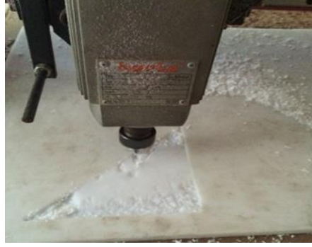
Resim-31 CNC Makinasının Corian Parçanın Yüzeyini Oyma İşlemini Yapması
