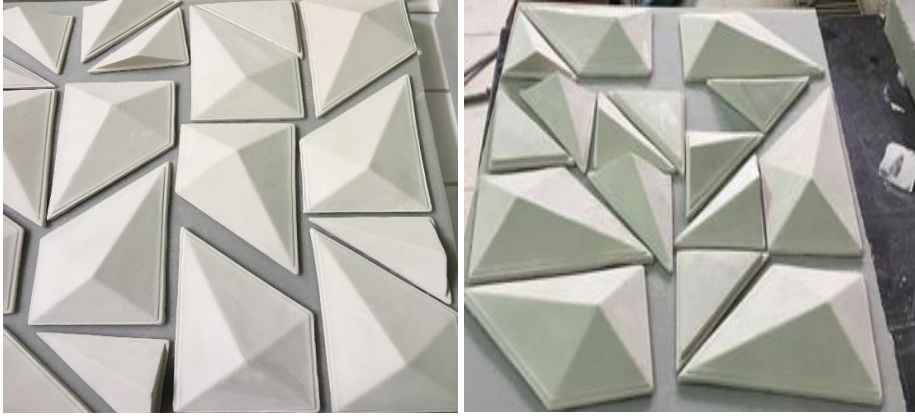
Resim -139 Porselen Modüllerin Kurutulması
