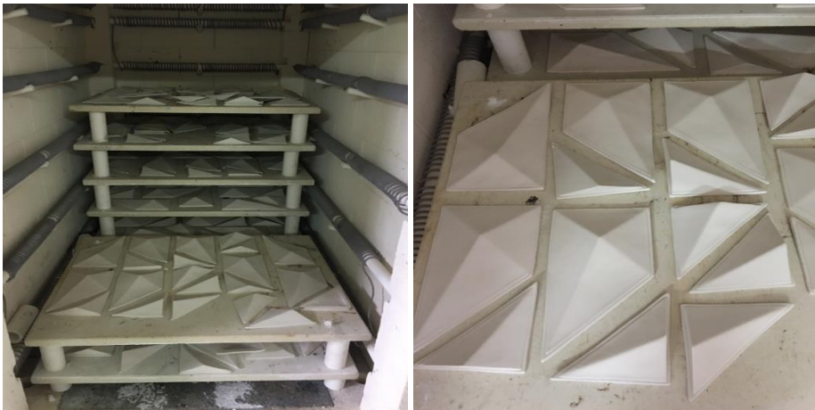
Resim -140 Porselen Modüllerin Pişirilmesi
