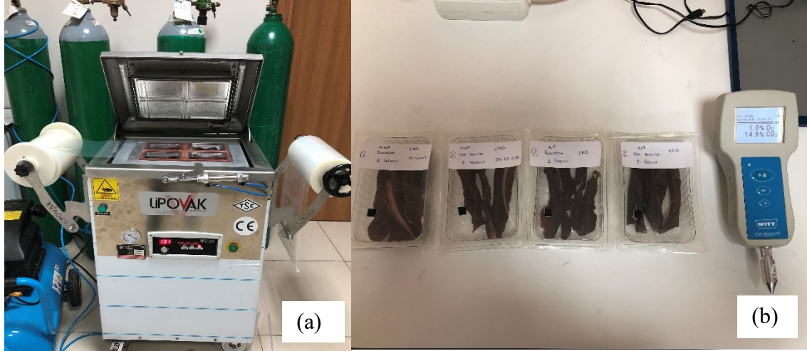
Şekil 3.6. a) Et dilimlerinin ambalajlanmasında kullanılan MAP cihazı; b) Ambalajlanmış örnekler
