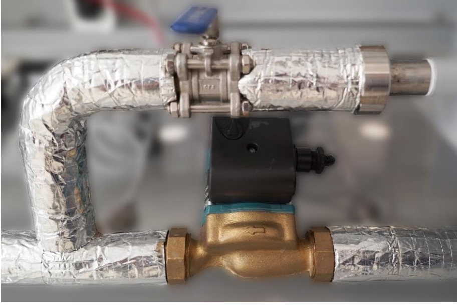
Şekil 3.21. Pompanın by-pass hattı ile beraber bağlantı şekli
