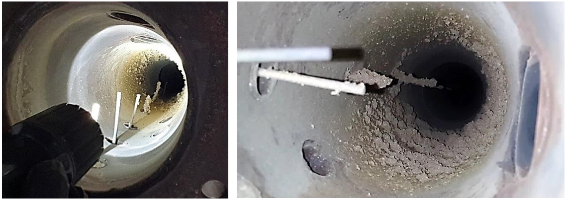
Şekil 4.24. Pirina (yatak malzemesi: kum) yakma deneyi sonunda yakıcı iç yüzeyinin görüntüsü (Deney 7; T_{yatak} = 850 \text{ } ^\circ\text{C} )
