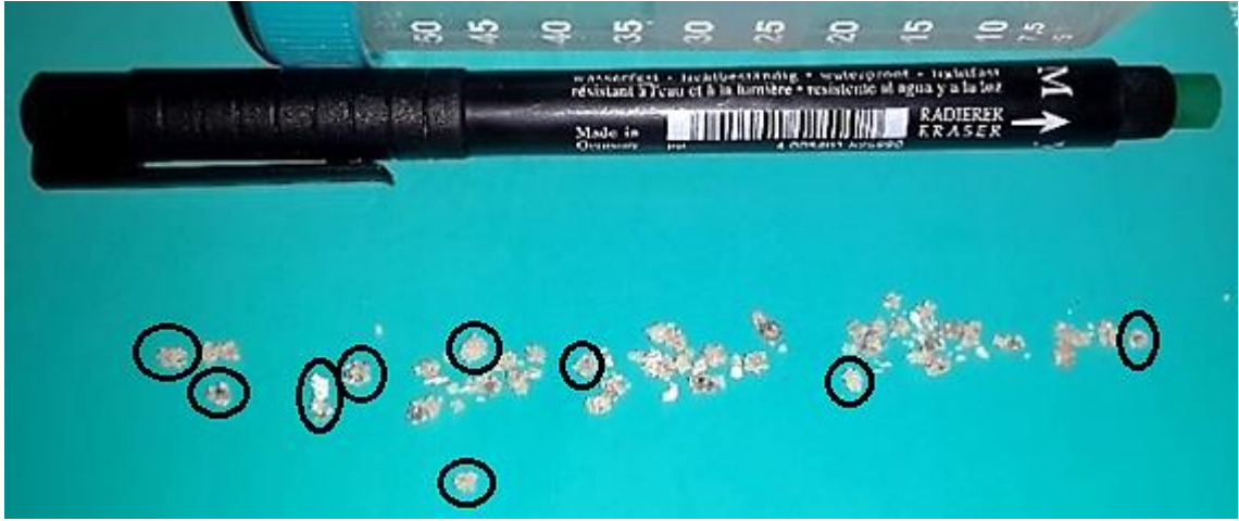
Şekil 4.21. Pirina (yatak malzemesi: kum) yakma deneyinde elde edilen topaklaşmış dip külü ve yatak malzemesinin görüntüsü (Deney 7; T_{yatak} = 850 \text{ } ^\circ\text{C} )
