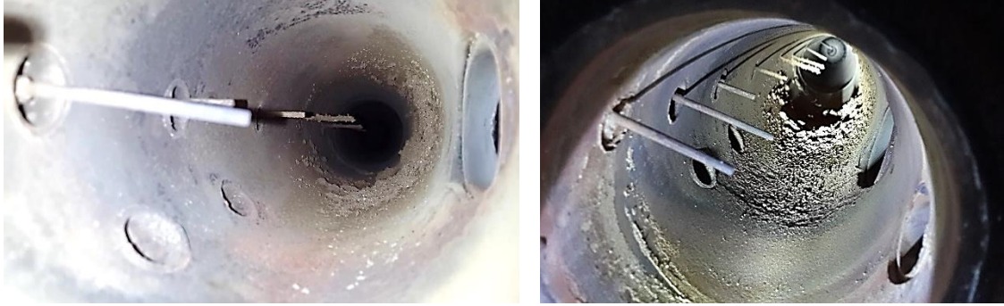
Şekil 4.41. Yıkılmış pirina (yatak malzemesi: kum) yakma deneyi sonunda yakıcı iç yüzeyinin görüntüsü (Deney 8; T_{yatak} = 850 °C)
