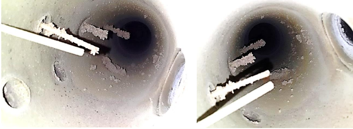
Şekil 4.50. Pirina (yatak malzemesi: kireçtaşı) yakma deneyi sonunda yakıcı iç yüzeyinin görüntüsü (Deney 9; T_{\text{yatak}} = 850 \text{ } ^\circ\text{C} )
