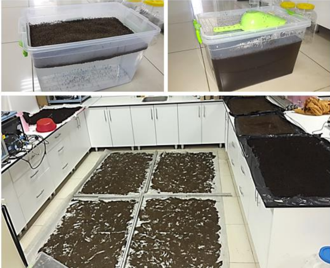
Şekil 3.3. Pirina yıkanma ve kurutma aşamaları
