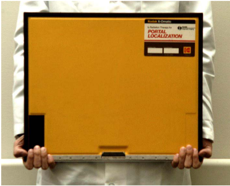
Şekil 2.14. Radyoterapi film kaseti. Bu cihazlar genel olarak 35 cm × 43 cm × 1.4. cm boyutlarına sahiptir (Antonuk 2002)
