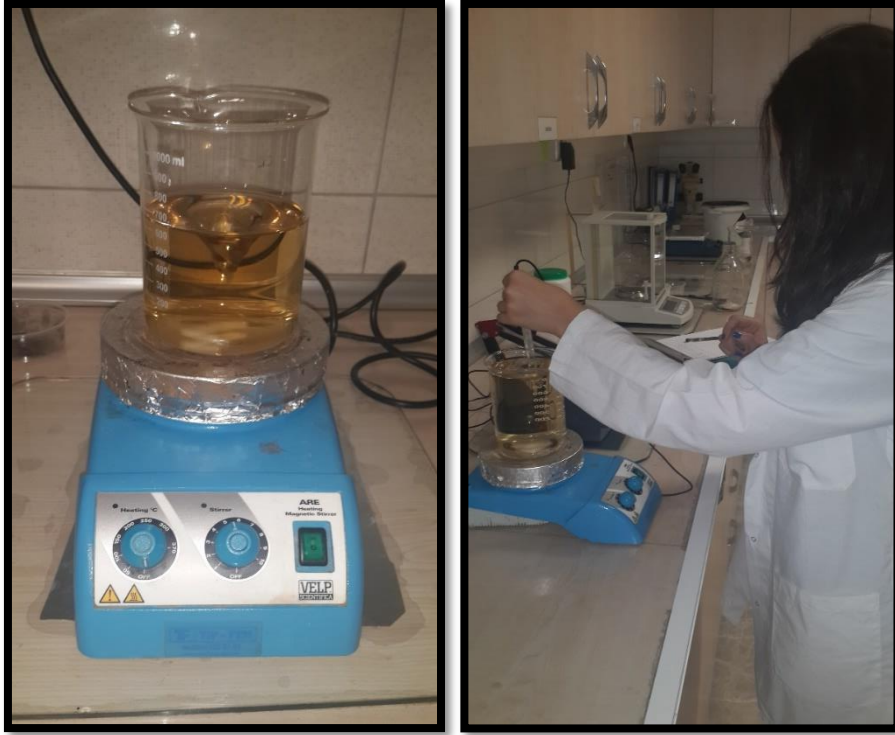
Şekil 3.7. MS temel besi ortamının hazırlanışı
