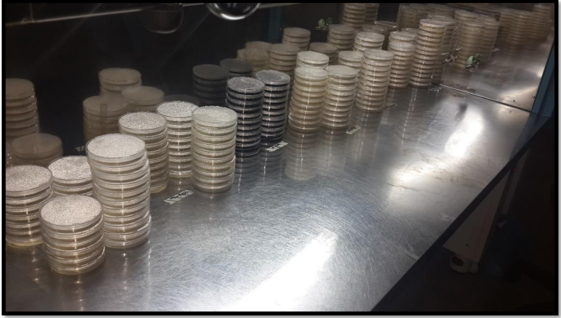
Şekil 3.10. Steril kabinde petrilere dökülen besin ortamları
