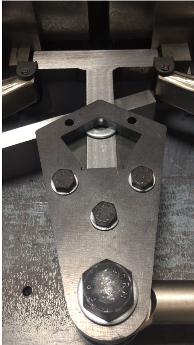
Şekil 3.7. Deney numunesinin deney düzeneğine bağlanması
