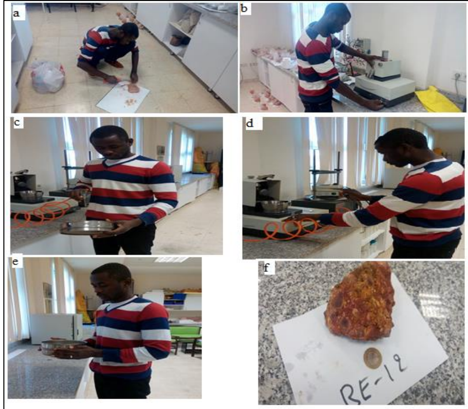
Şekil 3.2. Numunelerin hazırlanması aşamalarını gösteren laboratuvar fotoğrafları. a) Bir örnek boyutunu zeminde azaltılması, b) Retsch Mortar Grinder-RM200 Öğütücü kullanılarak bir örnek toz haline getirilmesi, c) 0.063 mikron eleğin kompresör ile kurutulması, d) Retsch Mortar Grinder-RM200'nin kompresör ile kurutulması, e) 0.063 mikron elek ile numunenin elenmesi, f) ince kesit hazırlama için hazırlanmış boksit numunesi
