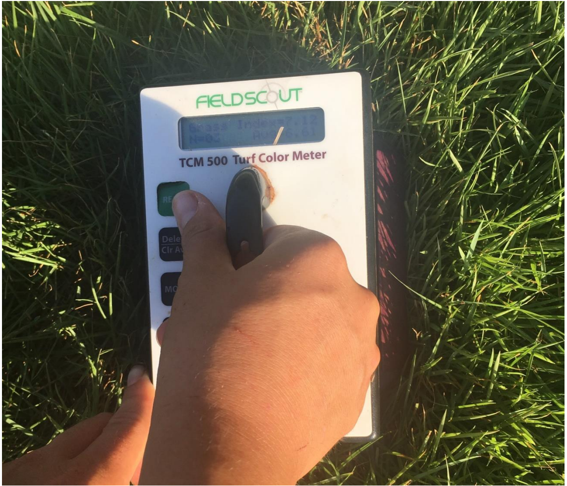
Şekil 4.4. Çim Renk/Kalite Ölçer (Turf Color Meter) ile çim indeks (grass index) değerlerinin ölçülmesi
