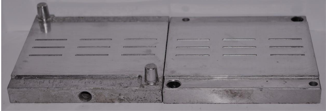
Şekil 3.5. Üç nokta eğme dayanımı test örneklerini hazırlamak için kullanılan kalıplar
