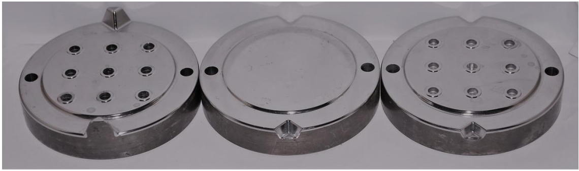
Şekil 3.7. Bağ dayanımı test örneklerini hazırlamak için kullanılan kalıplar
