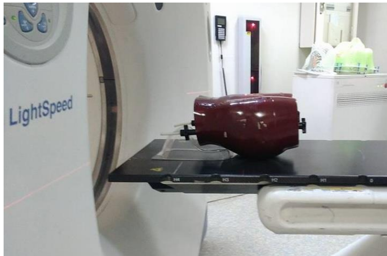
Şekil 3.2. Rando fantomun kesit görüntülerinin alınması (AÜROAD)
