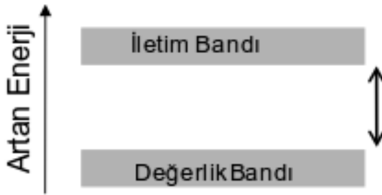
Şekil 2.1. CCD'nin enerji iletim mekanizması.
