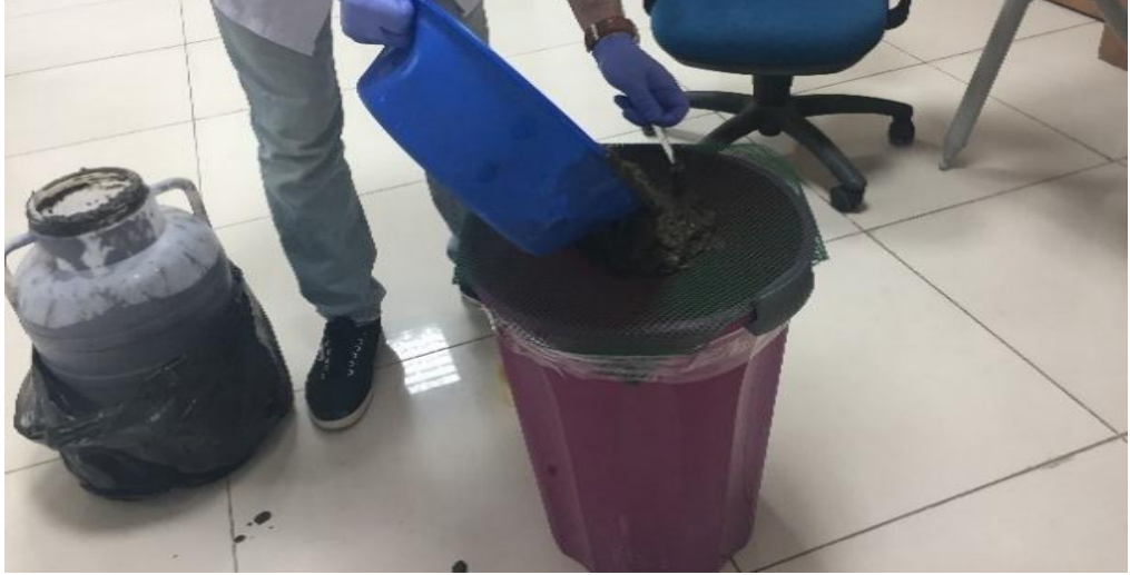
Şekil 3.2. Numunelerin elekten geçirilmesi
