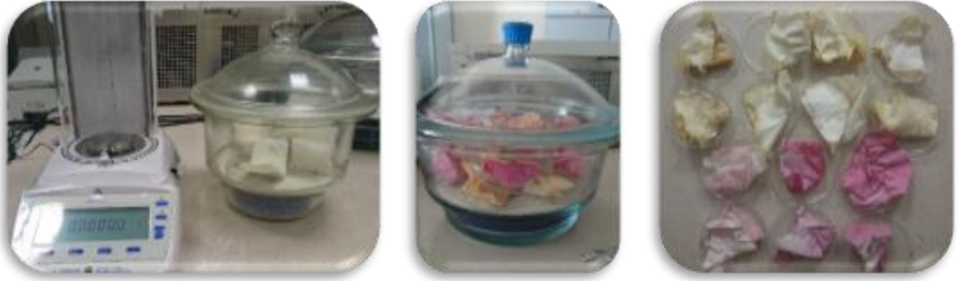
Şekil 3.12. Boş ve süzölmüş filtre kâğıtlarının desikatöre alınması ve tartımı
