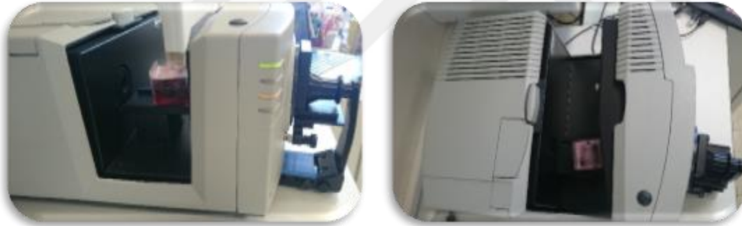
Şekil 3.9. UltraScan VIS HunterLab cihazında renk ölçümü
