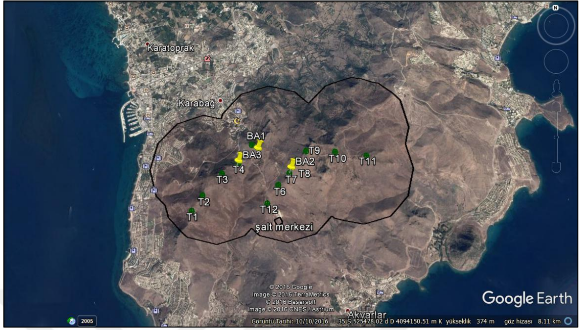
Şekil 3.23. Akyar RES sahasında Batcorder cihazının kurulduğu tüm noktalar (Yeşil noktalar proje kapsamında kurulması planlanan türbin noktalarını, sarı raptiye ile işaretli noktalar Batcorder cihazının kurulduğu noktaları göstermektedir)
