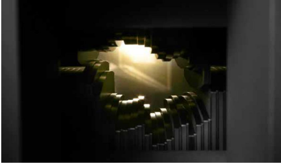
(Elekta Synergy® Platform lineer hızlandırıcı broşürü) Şekil 3.4. Elekta Synergy® Platform lineer hızlandırıcı cihazı MLC mekanizması
