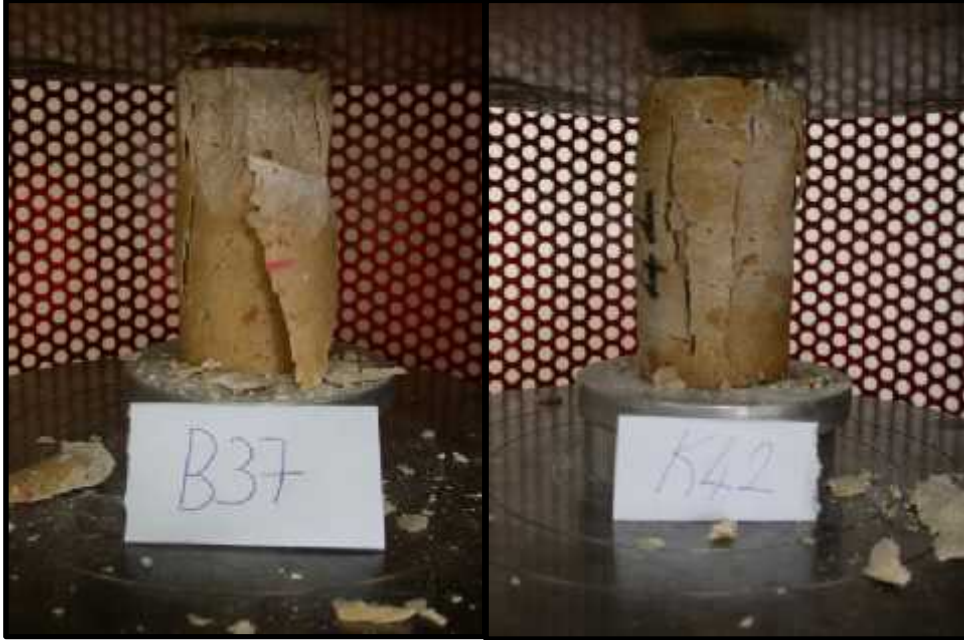
ekil 3.10. 3.grup (NaCl) örneklerden bazılarının yenilme sonrası durumu.
