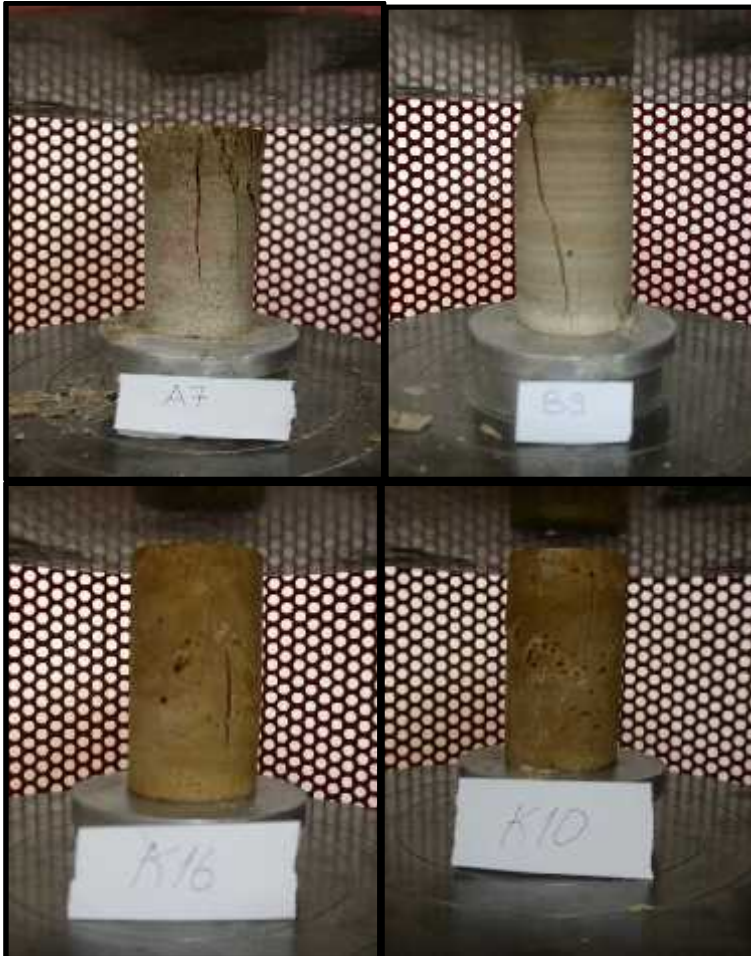
ekil 3.11. Kontrol numunelerinden bazılarının yenilme sonrası durumu.
