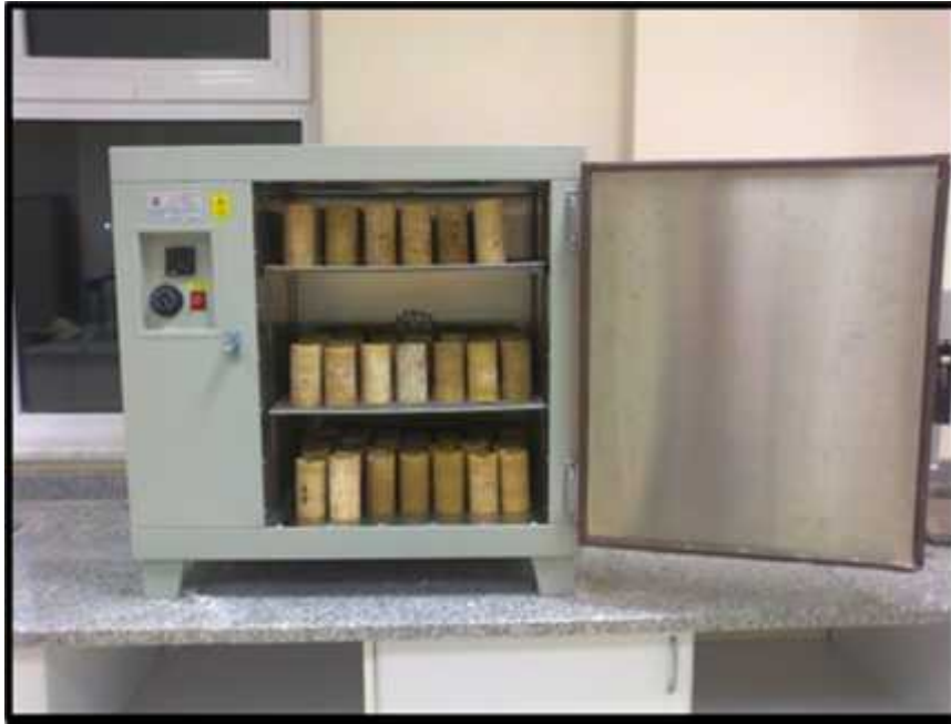
ekil 3.6. Etüve yerleştirilen karotların görünümü.
