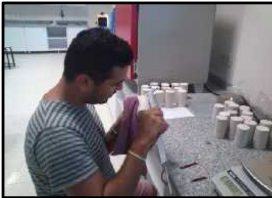
ekil 3.2. Silindirik örneklerin boyutlarının kumpasla ölçülmesi.
