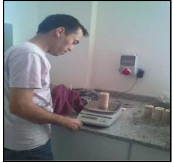
ekil 3.3. Örneklerin saf suda bekletilmesi ve suya doygun a ırlıklarının tartılması.
