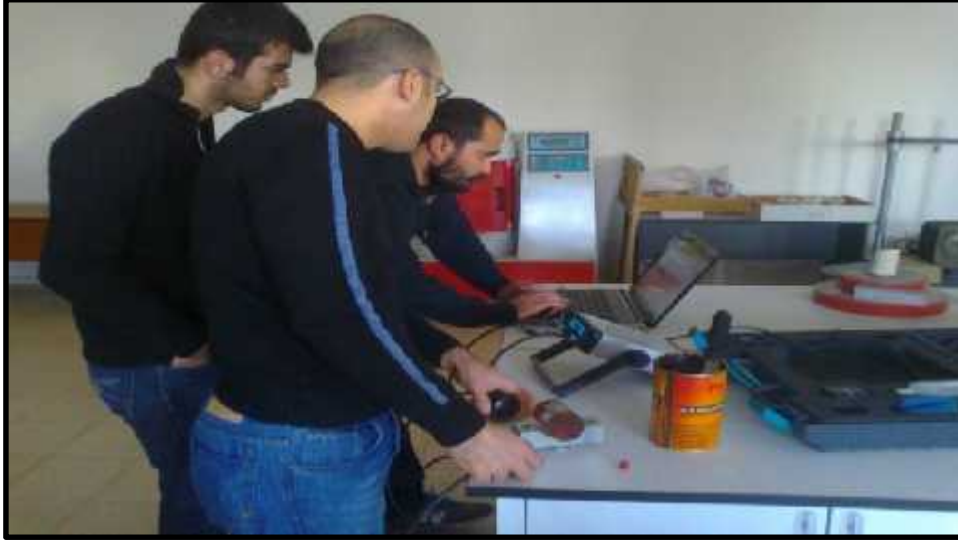
ekil 3.4. Sonik hız deneyinin yapılmı ı ve kullanılan Pundit cihazı.
