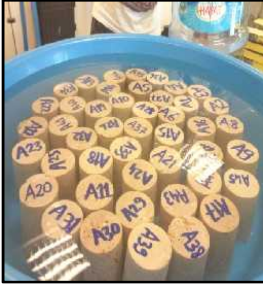
ekil 3.3. Örneklerin saf suda bekletilmesi ve suya doygun a ırlıklarının tartılması.
