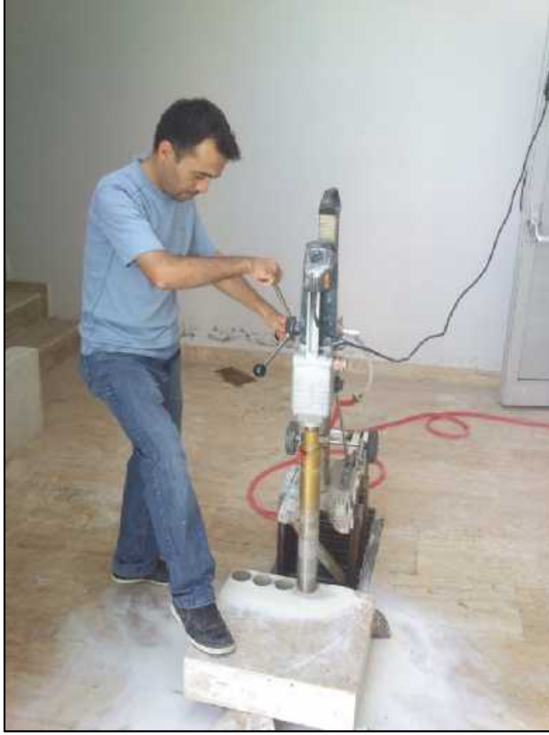
ekil 3.1. Karot alma makinesi ile karotların alınması.
