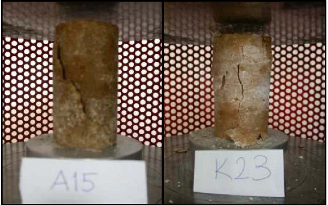
ekil 3.9. 2.grup ( Na_2SO_4 ) örneklerden bazılarının yenilme sonrası durumu.
