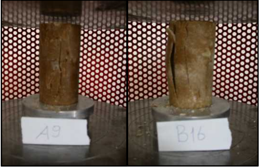
ekil 3.8. 1.grup ( MgSO_4 ) örneklerden bazılarının yenilme sonrası durumu.
