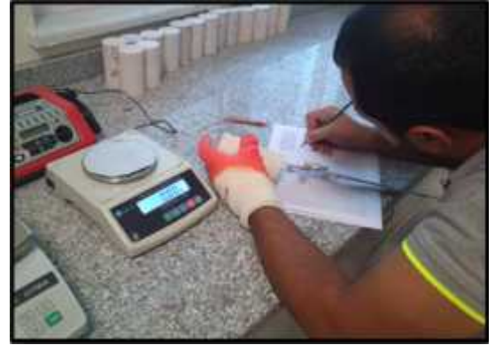
ekil 3.2. Silindirik örneklerin boyutlarının kumpasla ölçülmesi.
