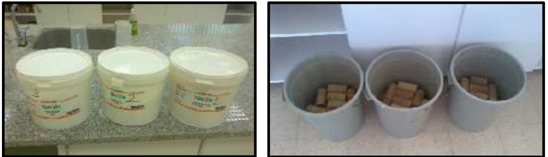
ekil 3.5. Deneylerde kullanılan tuzlar ve örneklerin tuzlu suya bırakılması.
