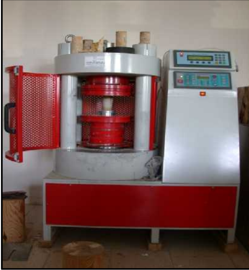
ekil 3.7. Tek eksenli sıkı ma dayanımı deneyinde kullanılan hidrolik pres.
