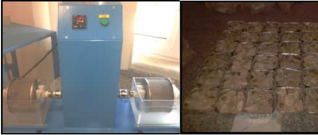
ekil 3.12. Suda da ılmaya kar ı duraylılık indeksi deneyinde kullanılan deney düzene i ve deneyde kullanılan örneklere ait görüntü.
