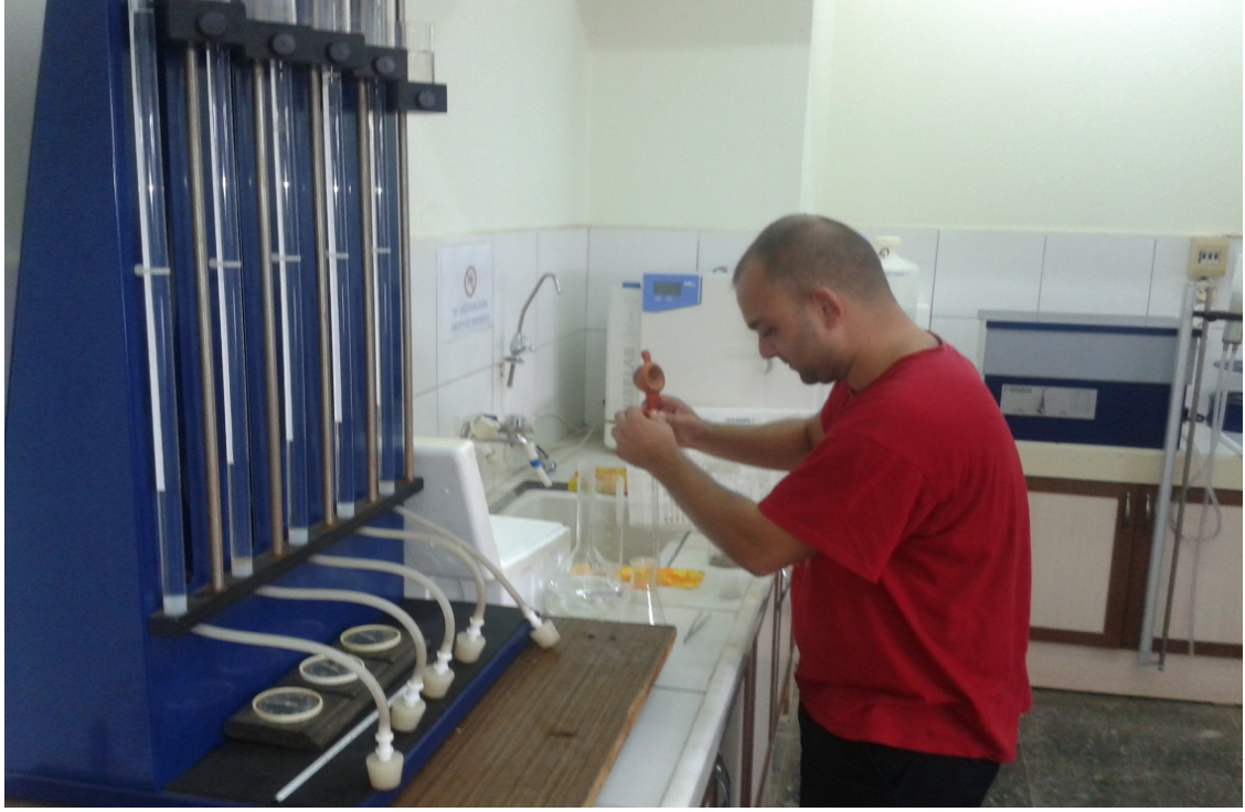
Şekil 3. 12. Toprak örneklerinin kireç ( \text{CaCO}_3 ) değerlerinin belirlenmesi.
