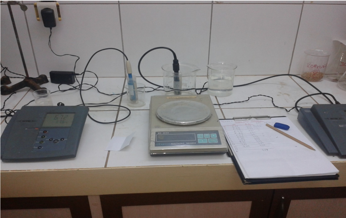
Şekil 3. 11. Toprak örneklerinin elektriksel iletkenlik (EC) değerlerinin belirlenmesi
