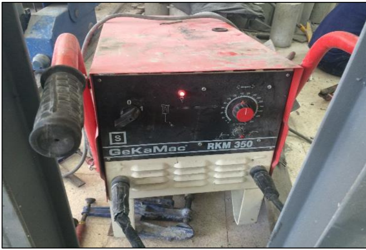
Şekil 3.27. Elektrik ark kaynağı üretici
