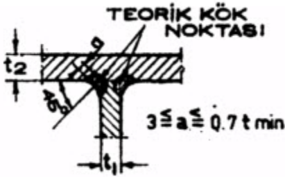
Şekil 1.3. Köşe kaynakta dikiş kalınlığı limitleri (TS 3357)
