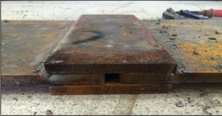
Şekil 3.31. Çift bindirmeli bağlantı yan görünüş
