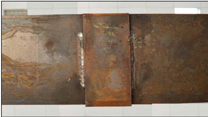
Şekil 3.30. Çift bindirmeli bağlantı üst görünüş
