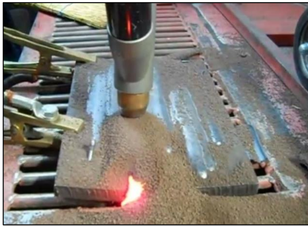
Şekil 2.10. Toz altı ark kaynağı yapılırken (Turan 2014)
