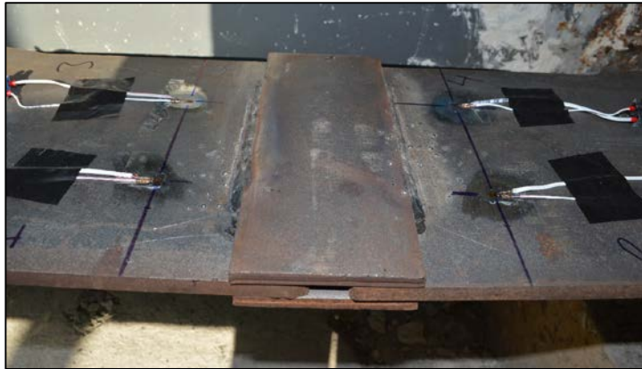
Şekil 3.35. Çift bindirmeli bağlantıda gerinim ölçerler
