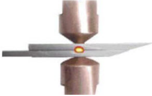
Şekil 2.15. Direnç nokta kaynağı (Gatwick Technologies 2016)
