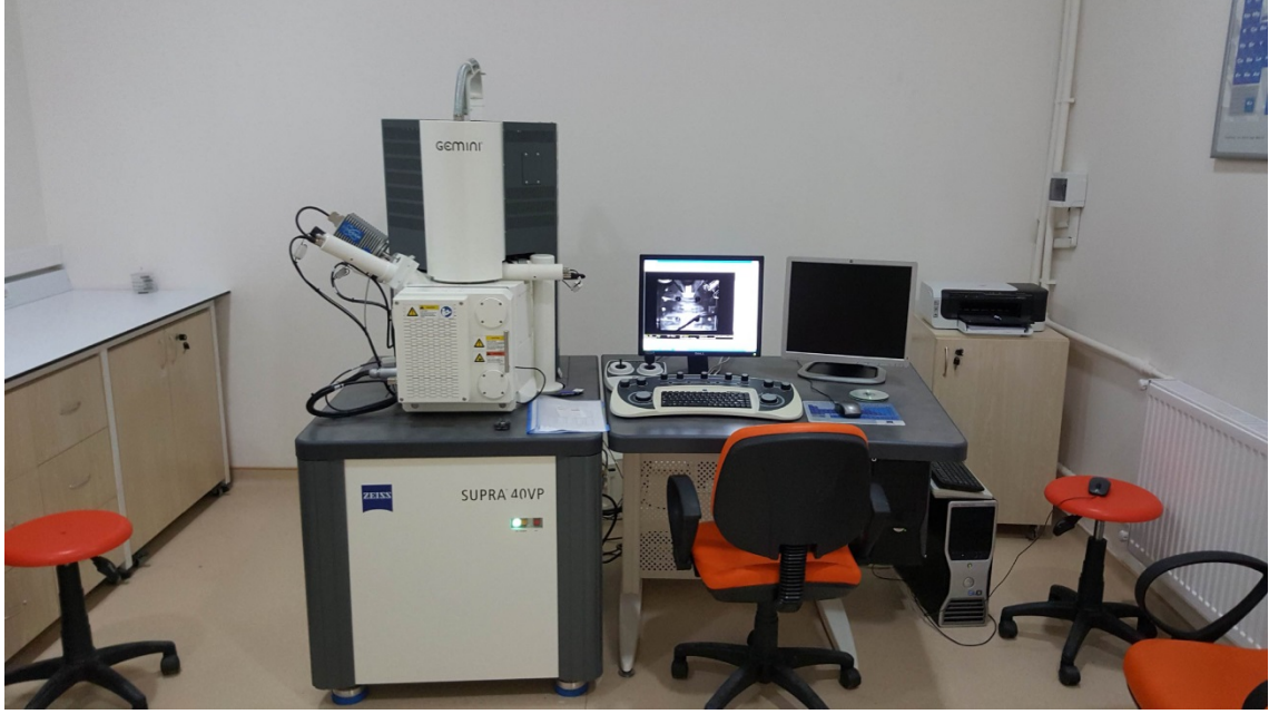
Şekil 3.9. ZEISS- SUPRA 40VP marka SEM cihazı
