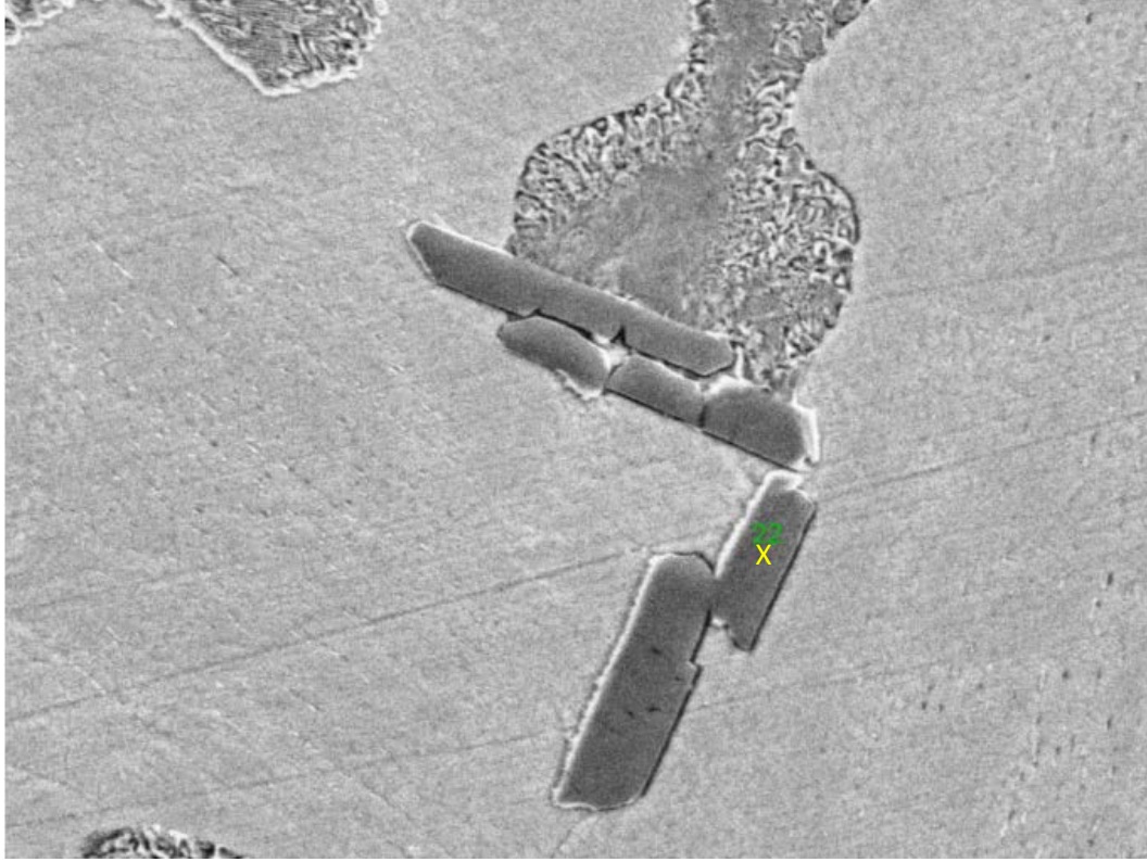
Şekil 4.50. Mn 0,057 450 600 kum, EDX analizi yapılan SEM görüntüsü
