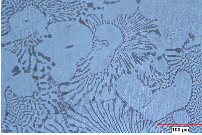
Şekil 4.56. Ti 0,03 650 600 kum, 200x optik mikroskop görüntüsü
