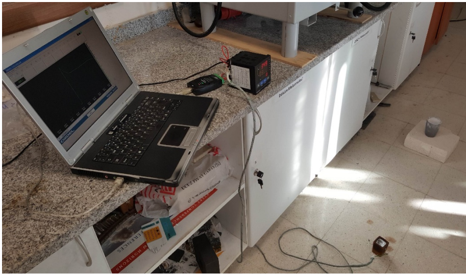
Şekil 3.17. Soğuma eğrisi analizi deney düzeneği. soldan sağa; kum kalıp, numune, bilgisayar, dönüştürücü ve adım kontrol ünitesi
