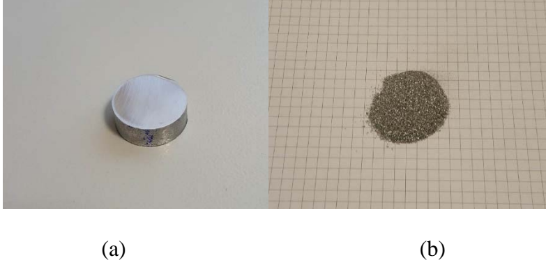
Şekil 3.10. a) XRF numunesi örneği b) ICP-OES numunesi örneği
