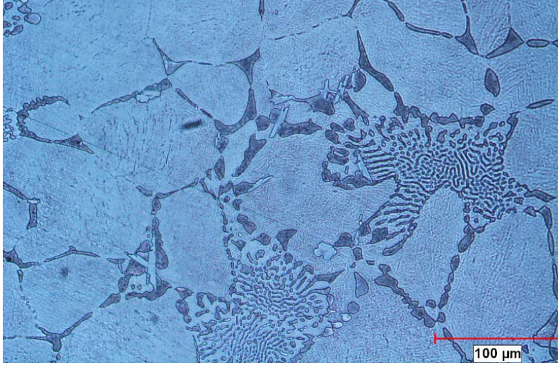
Şekil 4.48. Mn 0,057 450 600 kum, 200x optik mikroskop görüntüsü
