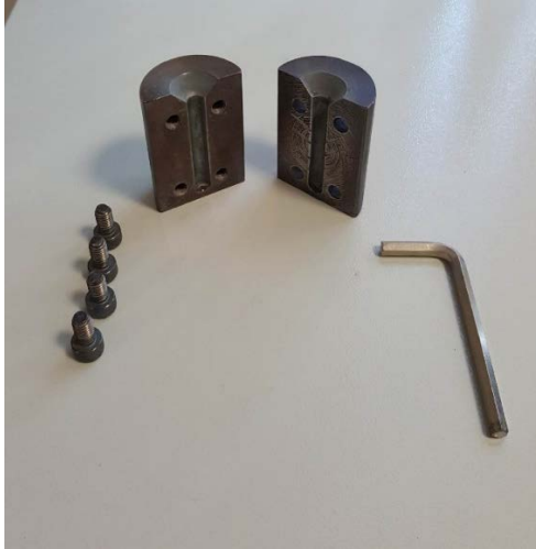
Şekil 3.2. 8 mm çaplı 3 nokta eğme numunesi kalıbı
