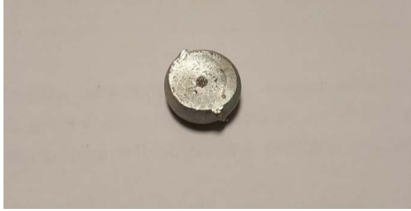
Şekil 4.80. Basma deneyi sonrası elde edilen numune örneği
