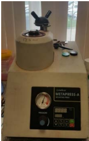
Şekil 3.11. Metkon METAPRESS-A MOUNTING PRESS marka bakalit makinası
