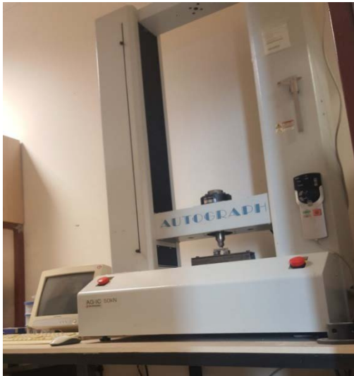
Şekil 3.13. 50 kN kapasiteli SHIMADZU AUTOGRADH A6-IC mekanik deney cihazı 3 nokta eğme deneyi düzeneği
