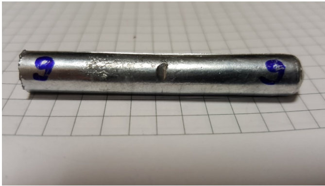
Şekil 3.3. Yüzeyi bozuk numune örneği
