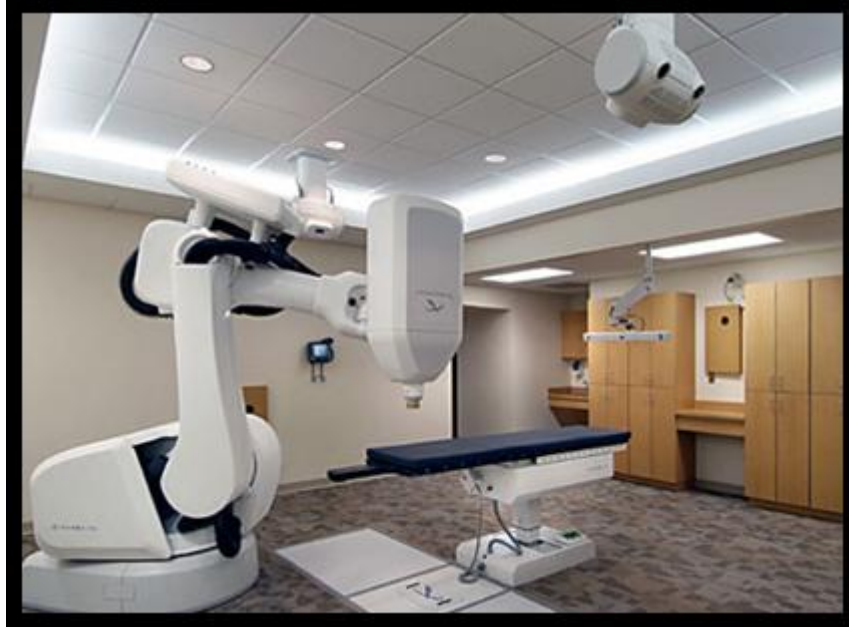
Şekil 2.6. CyberKnife Stereoskopik kV görüntüleme sistemi
