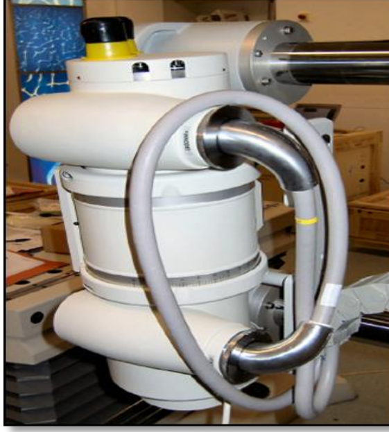
Şekil 2.24. Elekta Synergy XVI görüntüleme sistemi x-ışını tüpü
