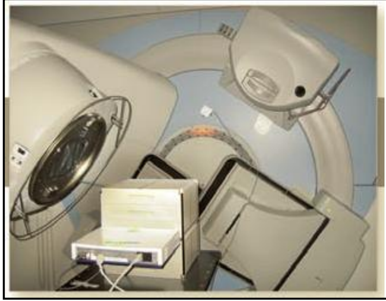
Şekil 3.25. 2D Array dozimetrik ölçüm düzeni
