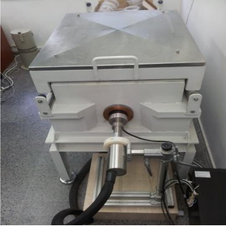
Şekil 3.4. Işınlanan numunelerin ölçümünde kullanılan HPGe detektörü
