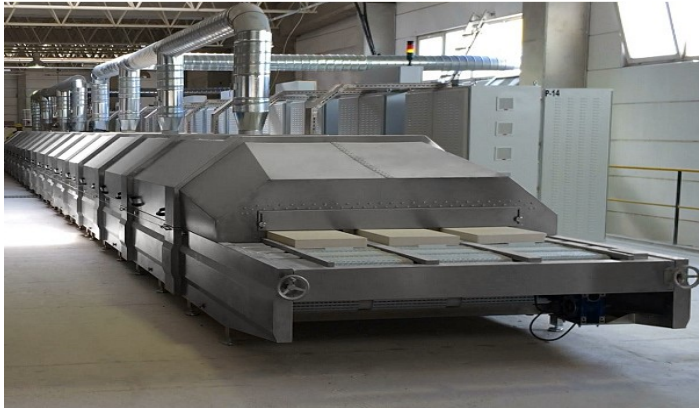
Şekil 1.2. Modüler bantlı endüstriyel mikrodalga fırın
