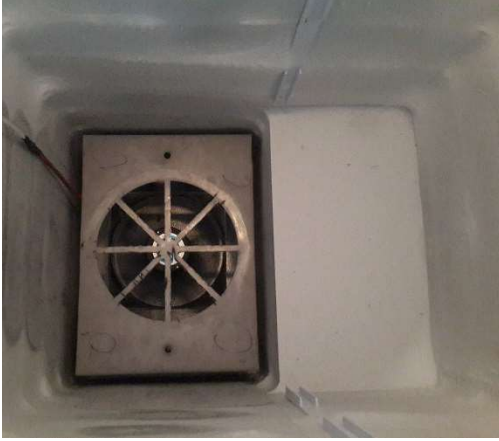
Şekil 3.4. Dondurucu içerisine yerleştirilen fan ve tepsiler
