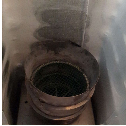
Şekil 3.4. Dondurucu içerisine yerleştirilen fan ve tepsiler
