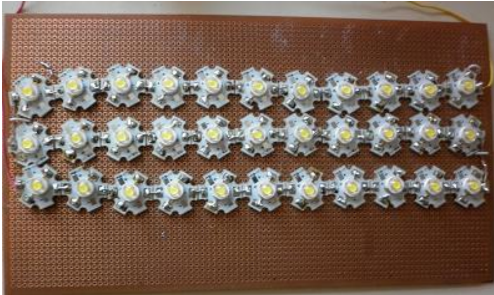
Şekil 3.12. LED modülünün yapısı
