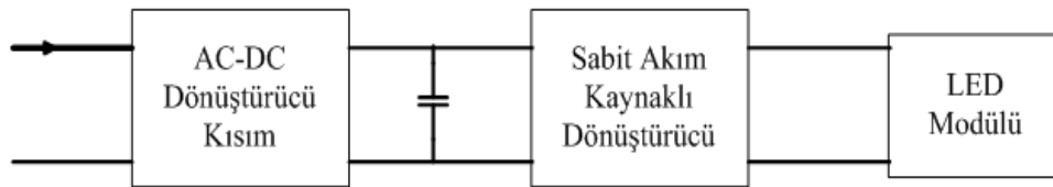
Şekil 2.8. Aktif LED sürücü devre şeması
