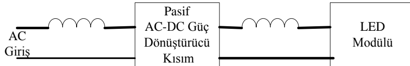
Şekil 2.6. Pasif LED sürücü devre şeması
