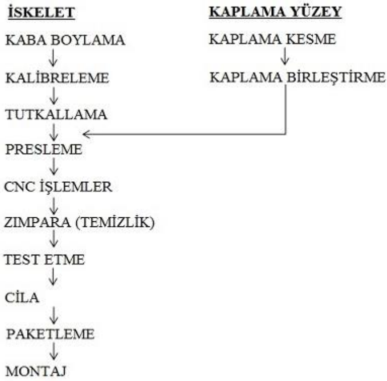
Şekil 4.5. Kapı Pervaz Üretim Süreci
