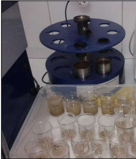
Şekil 3.14. “Eijkelkamp” marka ıslak eleme aleti kullanılarak gerçekleştirilen agregat stabilite analizi
