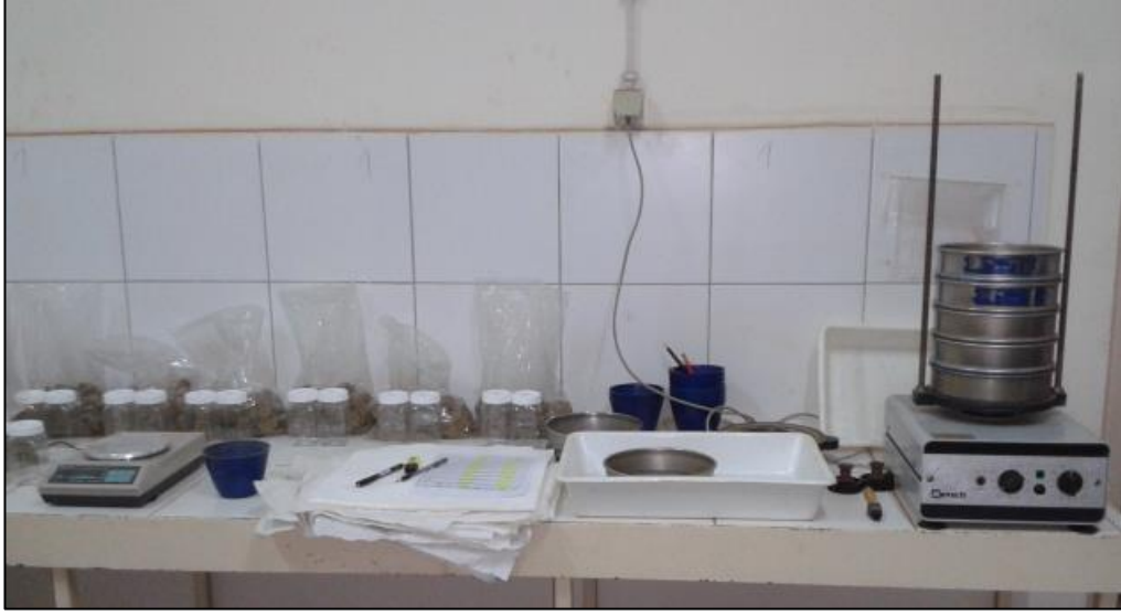
Şekil 3.13. Toprak örneklerinin Rotar elek makinasında agregat büyüklük dağılım analizlerinin gerçekleştirilmesi
