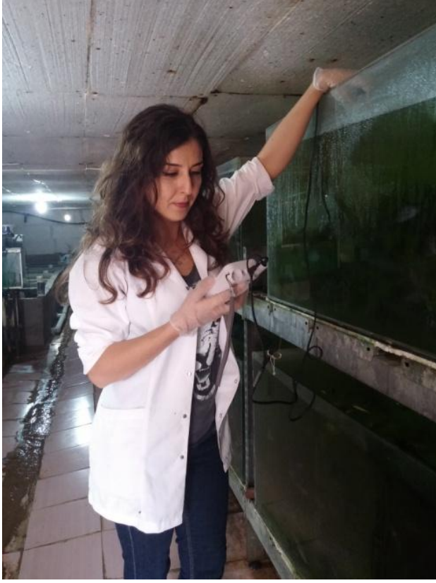
Şekil 3.2. İşletme koşullarında suyun sıcaklığı, çözünmüş oksijeni ve pH'ının ölçülmesi
