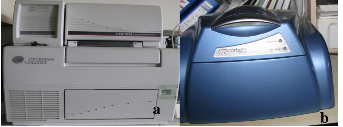
Şekil 3.11. Dizileme ve qPCR analizlerinde kullanılan cihazlar a) Sekans cihazı b) Real-Time PCR cihazı
