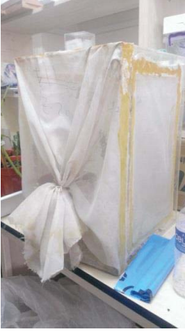
Şekil 3.3. Tuta absoluta erginlerinin yumurtlatıldığı pleksiglas kafes
