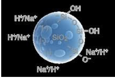
Şekil 3.2. Levasil ürünlerinde anyonik karakterli SiO 2 partiküllerinin gösterimi (Levasil 200S/30)
