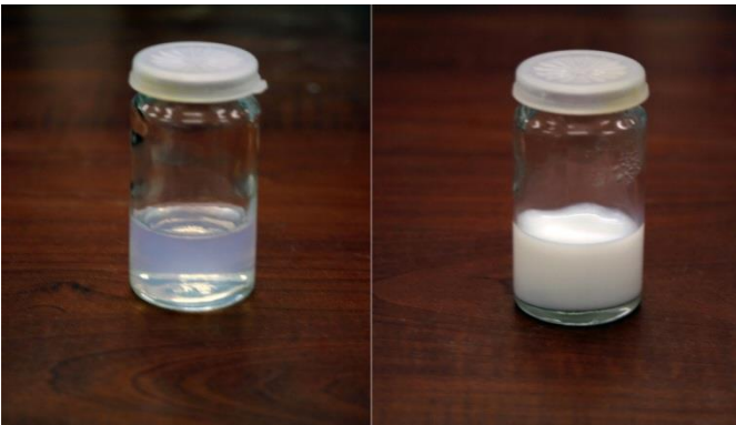
Şekil 4.28. (a) modifiye edilmemiş CeO_2 solü (b) MPTES modifiye edilmiş CeO_2 solü (c) modifiye edilmemiş TiO_2 solü ve (d) MPTES modifiye edilmiş TiO_2 solü
