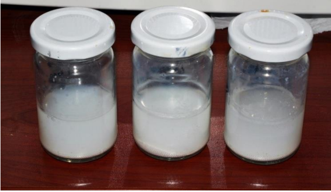
Şekil 4.27. Soldan sağa; 2 katı kadar katı GLYEO, MPTES ve AMMO ile modifiye edilmiş çinko oksit dispersiyonları, ( zamanla çökme devam etmekte)
