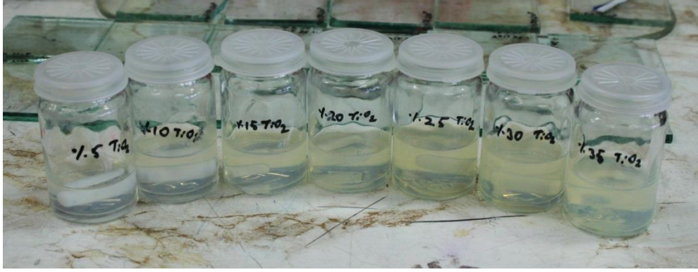
Şekil 4.57. Ağırlıkça %5 – 35 arası değişen miktarlarda TiO 2 katısı içeren çözeltiler (bkz: Çizelge 3.9)
