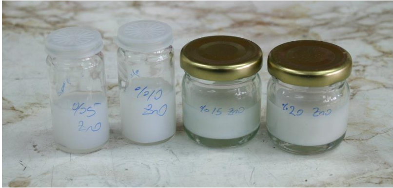
Şekil 4.59. Ağırlıkça %5 – 20 arası değişen miktarlarda ZnO katısı içeren çözeltiler (bkz: Çizelge 3.11)
