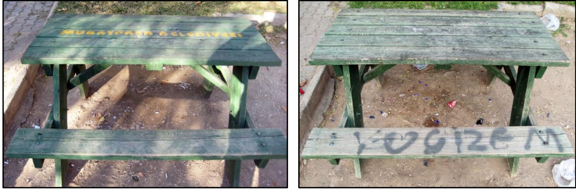
Şekil 4.15. Nayla Atay Parkı'nda bulunan P1 kodlu piknik masasında yapılan 1. ve 12. (aylık) gözlemler
