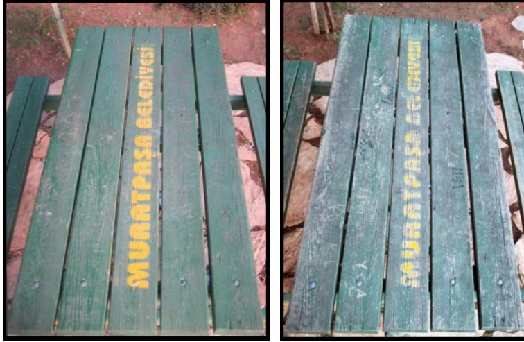
Şekil 4.16. Aydın Kanza Parkı'nda bulunan P3 kodlu piknik masasında yapılan 1. ve 12. (aylık) gözlemler
