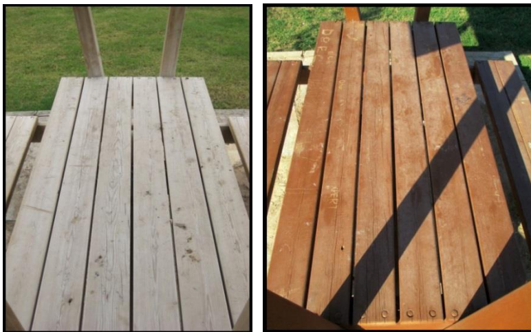
Şekil 4.18. Gazi Bulvarı Parkı'nda bulunan P4 kodlu piknik masasında yapılan 1. ve 12. (aylık) gözlemler
