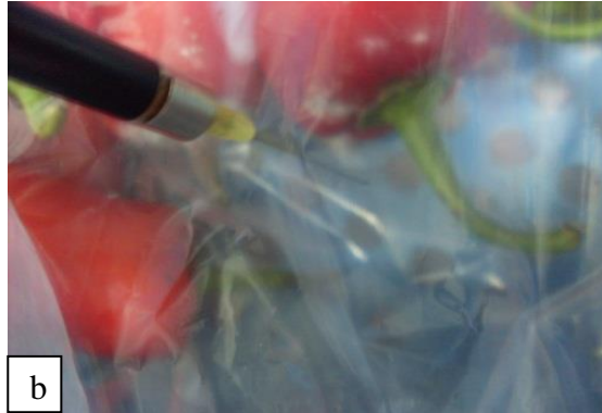
Şekil 3.25.b. MA torbaları içerisinde gaz konsantrasyonlarının ölçülmesi
