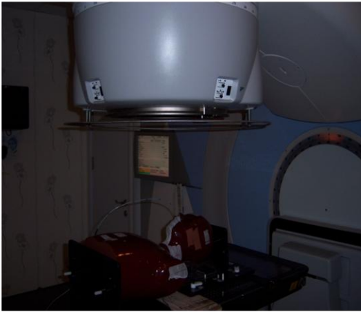
Şekil 3.24. Diyodun yerleştirildiği Rando fantomu linear hızlandırıcı cihazında ışınlanma düzeneği ve diyot doz ölçüm ekranı
