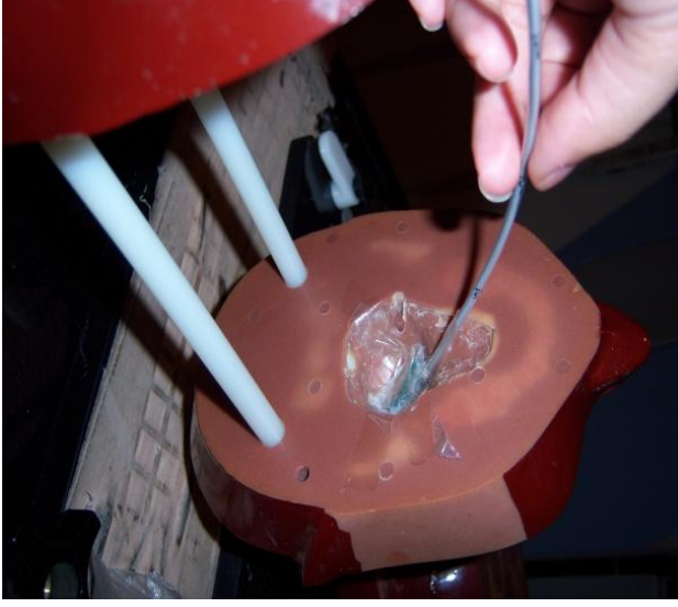
Şekil 3.22. Nazofarenks doz ölçümü için IDF-thin diyodun Rando fantom içine yerleştirilmesi
