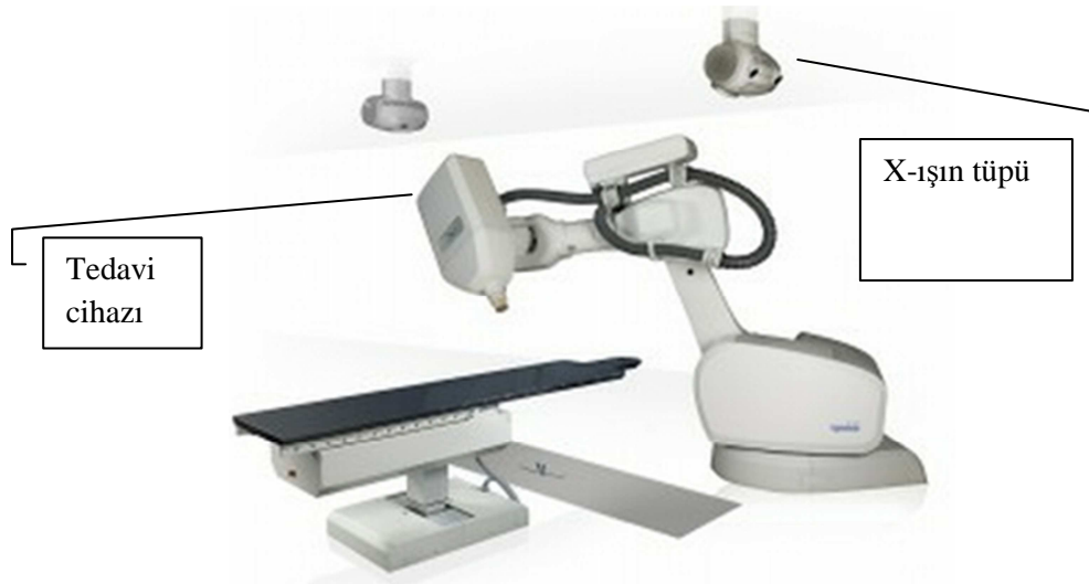
Şekil 2.7. Odaya monte görüntüleme cihazı
