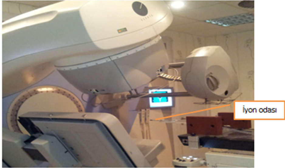
Şekil 3.16. FC65P tipi iyon odası
