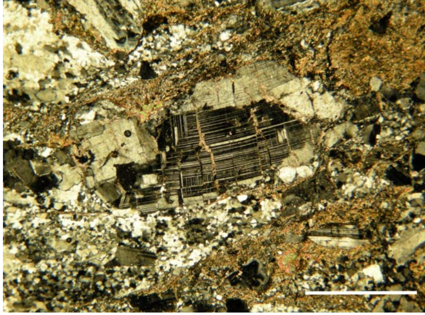
Şekil 3.10. Plajiyoklas mineralini enine kesen çatlak ve kırılğan deformasyonun genel görünümü (Çizgisel ölçek 1 mm)
